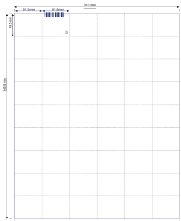
Figura 4 – Dimensões da bula aberta e esquema de dobras
